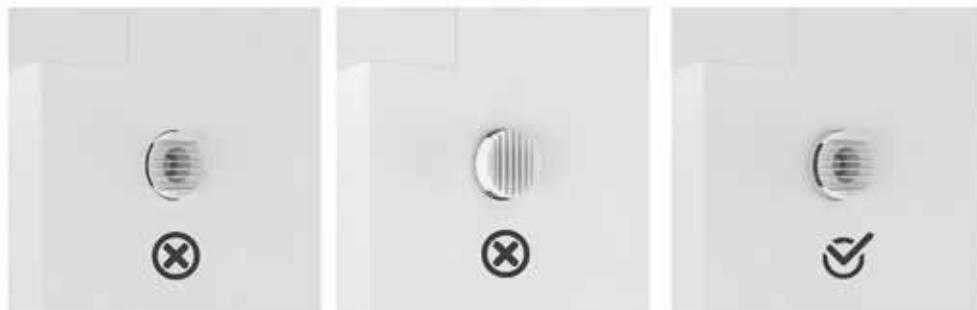
Otvor za odvod kondenzata mora biti postavljen vertikalno prema dole. Kondenzatno grejanje se nalazi na dnu, njegov završetak je postavljen u otvoru za odvod kondenzata i treba da se nalazi u najradijalnijoj tački.
